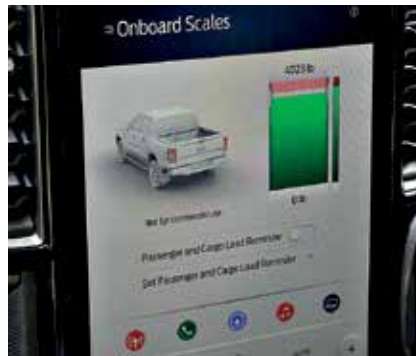
Χρησιμοποιώντας τους ειδικούς αισθητήρες φορτίου, η κεντρική οθόνη έχει χαρακτηριστικά... ζυγαριές για το ωφέλιμο φορτίο.
