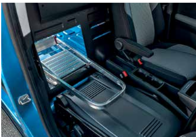
ΑΡΙΣΤΕΡΑ: Το ανακλινόμενο κάθισμα του συνοδηγού αφήνει χώρο για μεταφορά μακρύτερων αντικειμένων, όπως είναι π.χ. μία σκάλα ή σωλήνες. ΔΕΞΙΑ: Ο χώρος φόρτωσης είναι μεγάλος και η πρόσβαση διευκολύνεται από δύο πηευρικές συρόμενες πόρτες.
